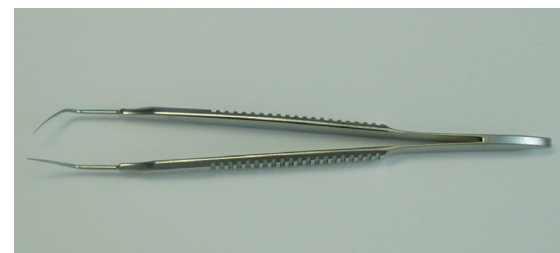
Fig. 2: Dommages mécaniques sur une pince de capsulorhexis Photo : Société Geuder
